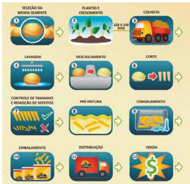
Figura 2. Processo de produção de batatas pré-fritas congeladas. Fonte: Mc Cain , 2014.
